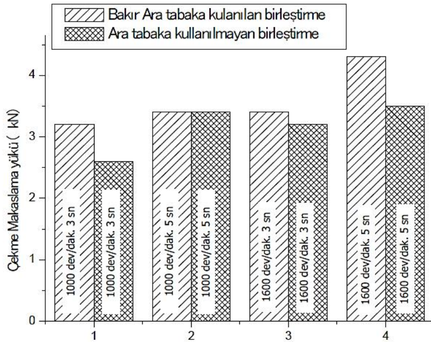
Şekil 12. Farklı dönme hızlarında ve farklı sürelerde yapılan SKNK işlemlerinin çekme makaslama yükü testi sonuçları [22].
