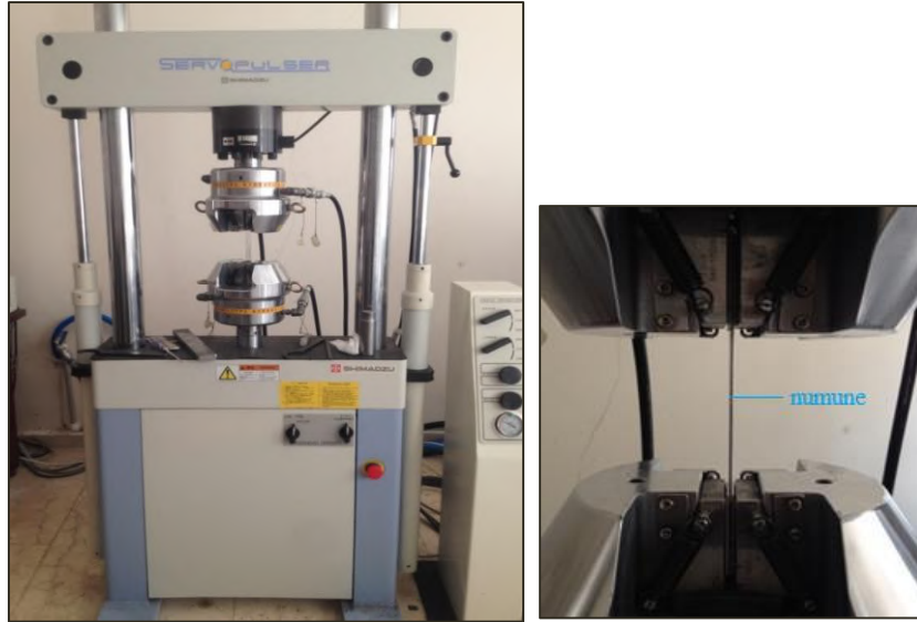
Şekil 5. Hidrolik yorulma test cihazı ve numunenin cihaza bağlanması
