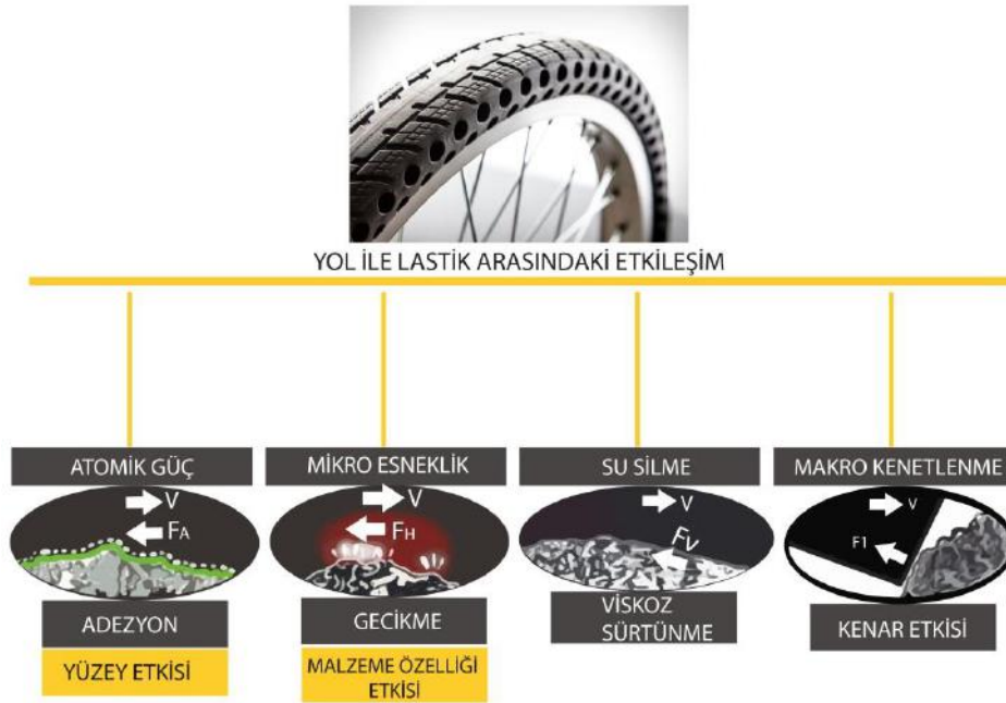
Şekil 1. Yol ile lastik arasındaki etkileşim kuvvetleri
