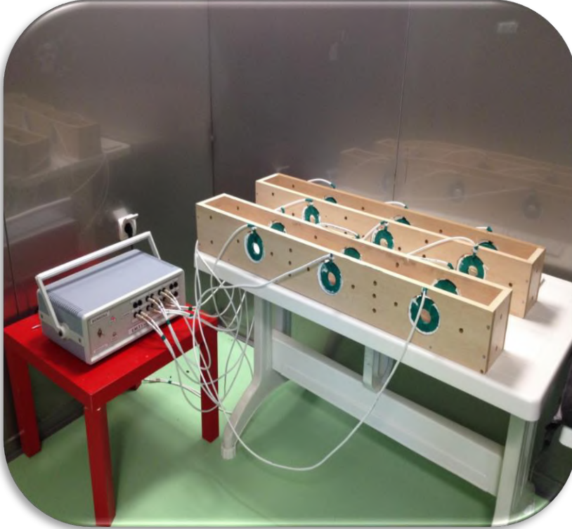
Resim 2: Darbeli Elektromanyetik Alan Cihazı, Bobinlerin Yerleştirildiği Düzenek ve Manyetik Alan Odası
