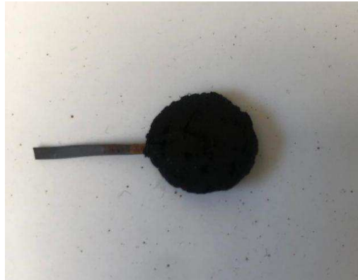
Şekil.1.Hazırlanan politiyofen elektrodun görüntüsü
